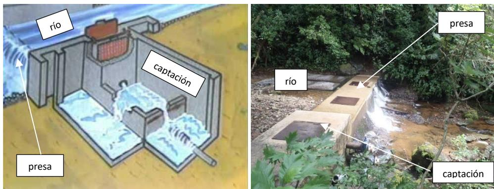
Figura 10. Captación de agua potable sobre un río o quebrada
